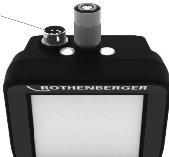
Figura 7 Conexiunile – prin cablu (tip conector „B”, conector argintiu cu 5 pini)
