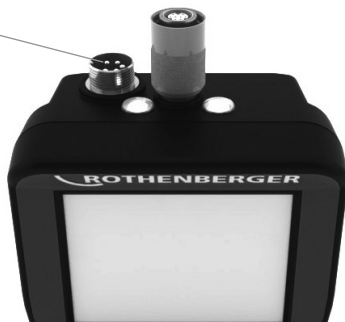
Pilt 7 - Kaabliühendused (pistmik „B“, värvus hõbedane, 5-pooluseline liitmik) (pistmikku „B“ kasutatakse ROSCOPE moodulite varasemate versioonide paigaldamiseks ROSCOPE i2000 külge)
