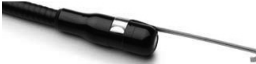
Figure 9 - Installation d'un accessoire sur le connecteur A de l'imageur
