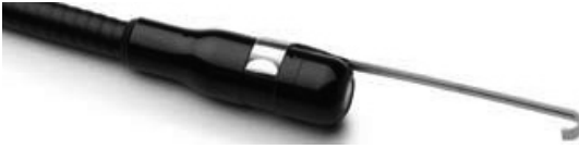
Şekil 9 – Konektor “A” görüntüleyiciye Aksesuar Takılması
