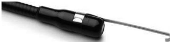
Figura 9 - Instalarea unui accesoriu pe conectorul de imagistică „A”
