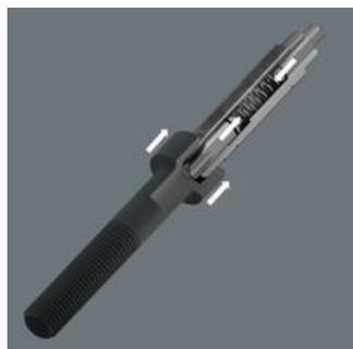
Mit dem 4-in-1 Bit 9507 können drei Größen Innensechskantschrauben (2,5; 5,0; 6,0) und eine Größe TORX® Schrauben (TX 25) betätigt werden. Um das jeweils größere Profil zu verwenden, muss beim Schrauben kontinuierlich gegen die Federkraft gedrückt werden, so dass das kleinere Profil versenkt wird und das größere Profil eingesetzt werden kann.
