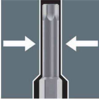
Die Bitnüsse verfügen über einen 30 mm langen und extra schlanken Profilbereich. Hierdurch sind auch Verschraubungen in engen Arbeitsräumen gut zugänglich.
