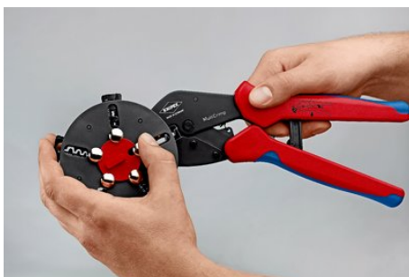
Crimpeinsatz-Wechsel: Magazinposition entsperren, Crimpeinsatz in der Zange entnehmen
